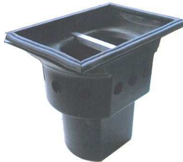
Artikel: HW-R2004.20 Maße: 400x265 mm Bei Ausklinkarbeiten vor Ort kann der Flansch von Hand zugeschnitten werden. Mit angebauter Ausgleichschürze aus Weichgummi
