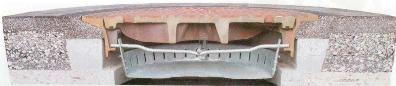
Abbildung 5: Bituplan – Schnittbild mit schematischer Darstellung
