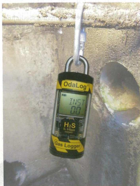
Der H 2 S-Datenlogger OdaLog L2 wurde speziell für die Abwasserindustrie entwickelt.
